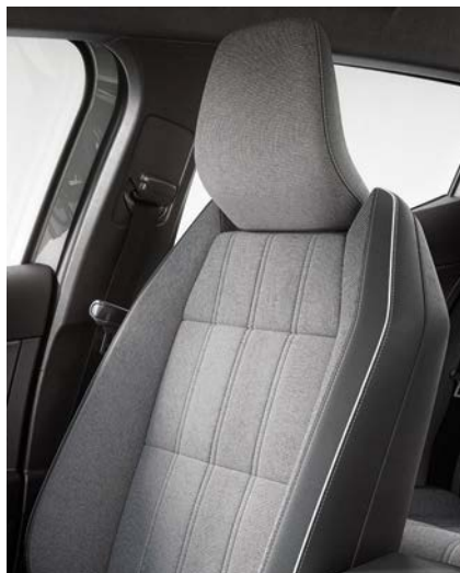
materiāls, kas izgatavots no pārstrādātas ELZA REC salona apdares un izmantots apvienojumā ar pelēkiem TEP ādas elementiem.
